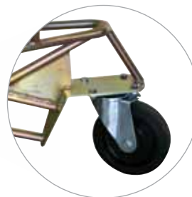
Lenkrolle kein ständiges Anheben des Vorderrades notwendig um Geradeauslauf zu garantieren
