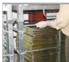
alle Querrohre können zum Be- und Entladen entnommen werden
