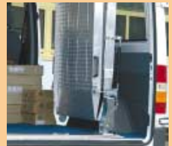
Die Rampe ist sowohl nach außen wie auch ins Fahrzeuginnere drehbar.
