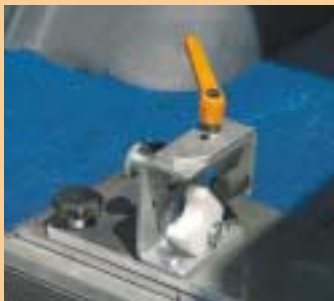
Lagerbock zur Arretierung der Rampe im Innenraum.
