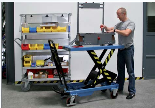
Zum Montieren und Arbeiten in ergonomischer Höhe: Aktivierung der Hydraulikpumpe über das Fußpedal. Das Senkventil wird über den Handhebel betätigt.
