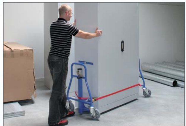
Möbelhubroller mit Hand-Spindelwinde für den sicheren Ein-Mann-Transport von schweren Schränken, Kisten und anderen sperrigen Gütern.
