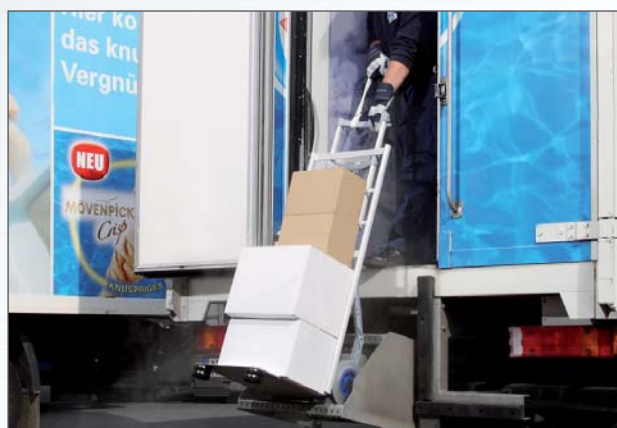
Dank der Halteschleufe und den Stützkußen kann die Tiko-Karre bequem und sicher über die Tritte des Kühlwagens heraufgezogen und herabgelassen werden.
