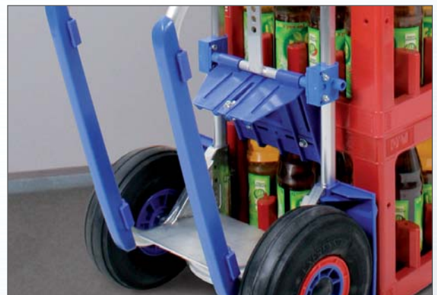
Das höhenverstellbare Pendel dient zur Aufnahme unterschiedlicher Getränkeboxen. Um das Pendel zu nutzen, wird die Schaufel Nr. 2 nach hinten durchgeklappt.
