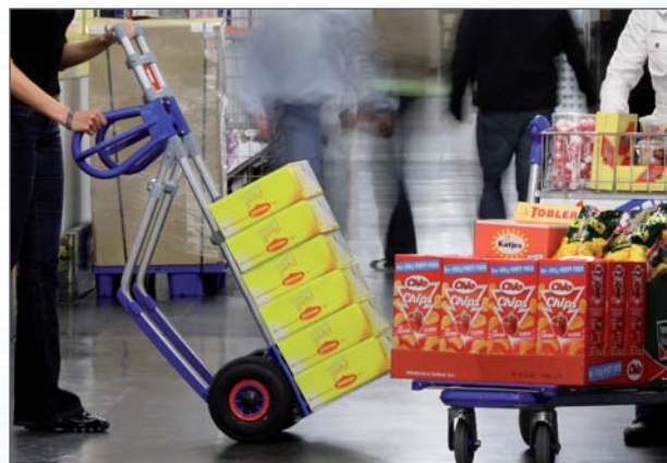
Die gewölbten, glasfaserverstärkten Querverbindungen tragen maßgeblich zur Stabilität der Stapelkarren bei; die obere dient als Handgriff. (SB-Wagen s.S. 67)
