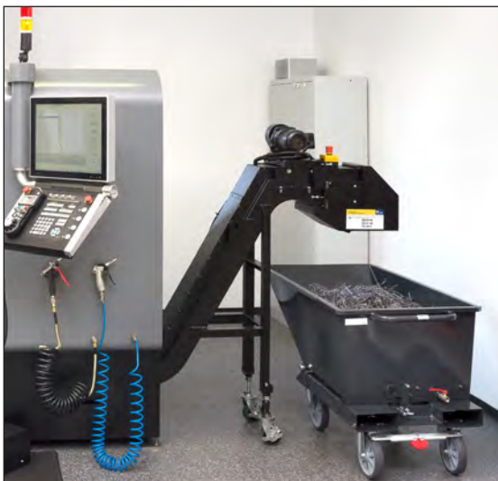
Anwendungsbeispiel: Muldenkipper als Spänebehälter
